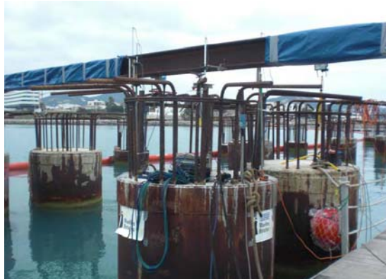
Figura 1. Instrumentación del pilote a ser ensayado con la célula Osterberg y viga de referencia.
